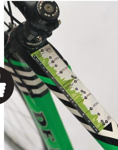
**COLLER LE PROFIL AUTOCOLLANT SUR L'AVANT DU TUBE SUPÉRIEUR DE VOTRE CADRE.**
